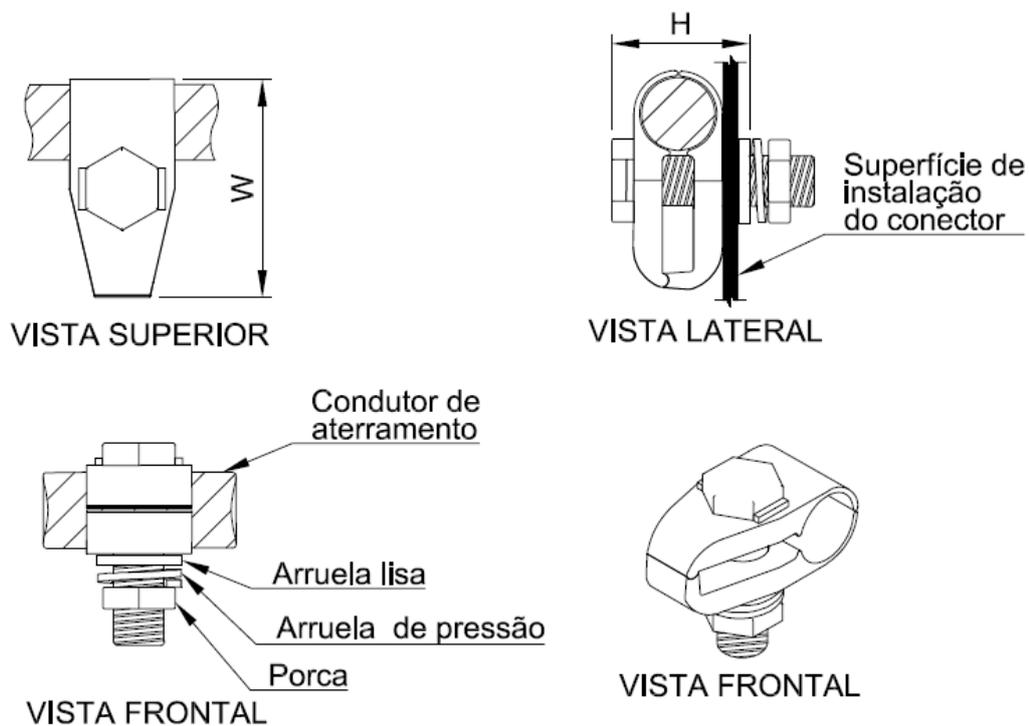
Figura 1 – Conector de aterramento
